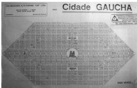
**Figura 3. Traçado de Cidade Gaúcha, Américo Sato, 1953. Composição simétrica e arranjo artístico de vias, edifícios, espaços livre e arborização. Fonte: Cartório de Registro de Imóveis de Campo Mourão.**
